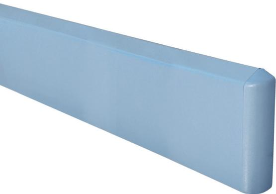
Il più classico dei paracolpi, con rivestimento esterno in Life-blend®, rettangolare, adatto per forti impatti, con profilo sottostante continuo in alluminio, sul quale viene applicato a scatto il rivestimento elastico in modo da poterlo rimuovere e sostituire all'occorrenza. Installabile anche su pareti in cartongesso a doppia lastra.
